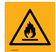
A021 Brannfarlig materiale
